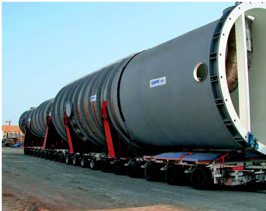
2507 不锈钢降膜蒸发器（来源：Gary Carinci,TMR 不锈钢）
