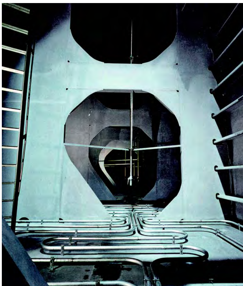
海上化学品船 2205 (1.4462) 液货舱内部 (来源: ThyssenKrupp Nirosta)
