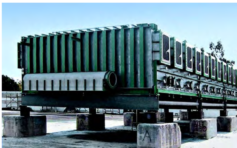
用 S32101 和 S32205 双相不锈钢制造的多级闪蒸海水淡化装置（来源：Outokumpu）
