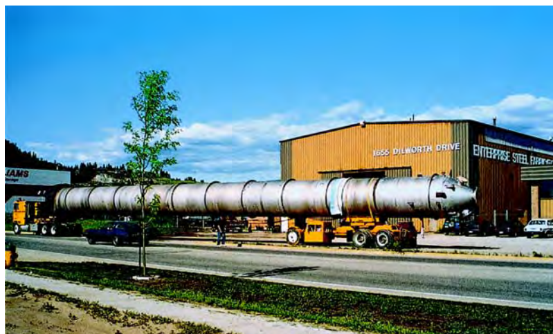
加拿大不列颠哥伦比亚省乔治王子城 Kalowna, Enterprise Steel Fab 的 2205 氧脱木素反应器（来源：Outokumpu）
