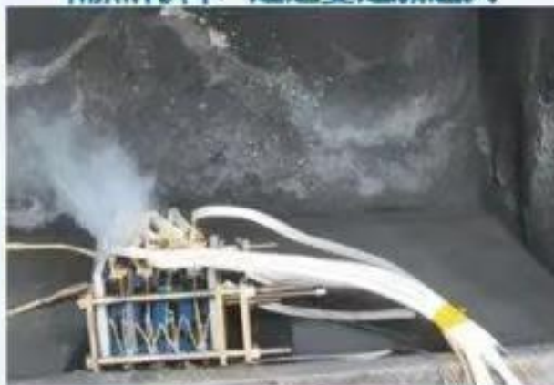
隔热材料：延迟蔓延加起火
